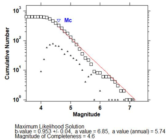
**Gambar 5.** Estimasi *Mc* didasarkan pada data USGS.
