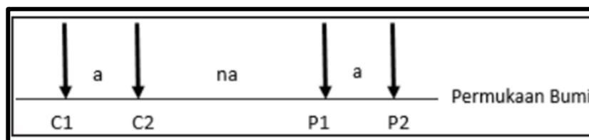
**Gambar 3.** Konfigurasi *dipole-dipole* modifikasi dari (Sheriff, 2001).
