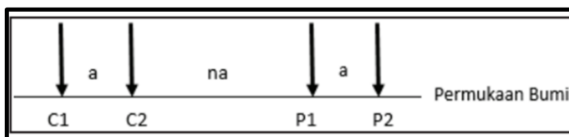
Gambar 2. Konfigurasi dipole-dipole modifikasi dari (Sheriff, 2001).
